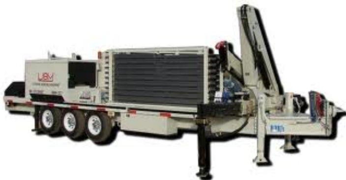
передвижная строительная машина UBM-120
